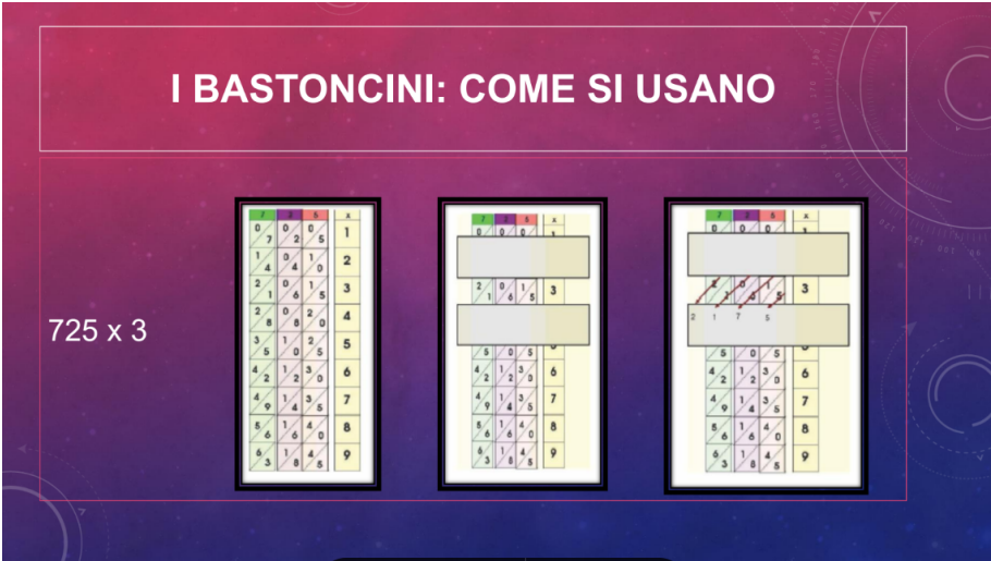
Fig. 5 Esempio di moltiplicazione: i bastoncini dei numeri 7, 2 e 5 allineati per il calcolo
