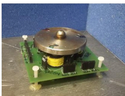
Fig. 2: VEH realizzato dal gruppo di Elettrotecnica del Dipartimento di Ingegneria dell'Università degli Studi del Sannio.
